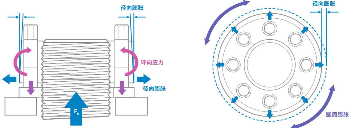
在螺栓的轴向载荷作用下，Superbolt 多项推预紧器的螺母主体承受环向应力，而发生径向膨胀（顶端向内收缩，底部向外扩张）。
