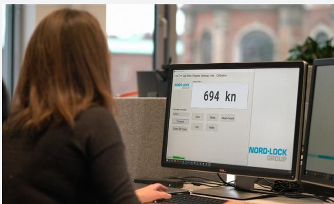
在 LST 诞生以前，这种例行检查需要耗费大量精力且需要对既有螺栓连接进行改造。如今，LST 可以实现预紧力的远程实时监控，而无需对螺栓连接做任何改动。
